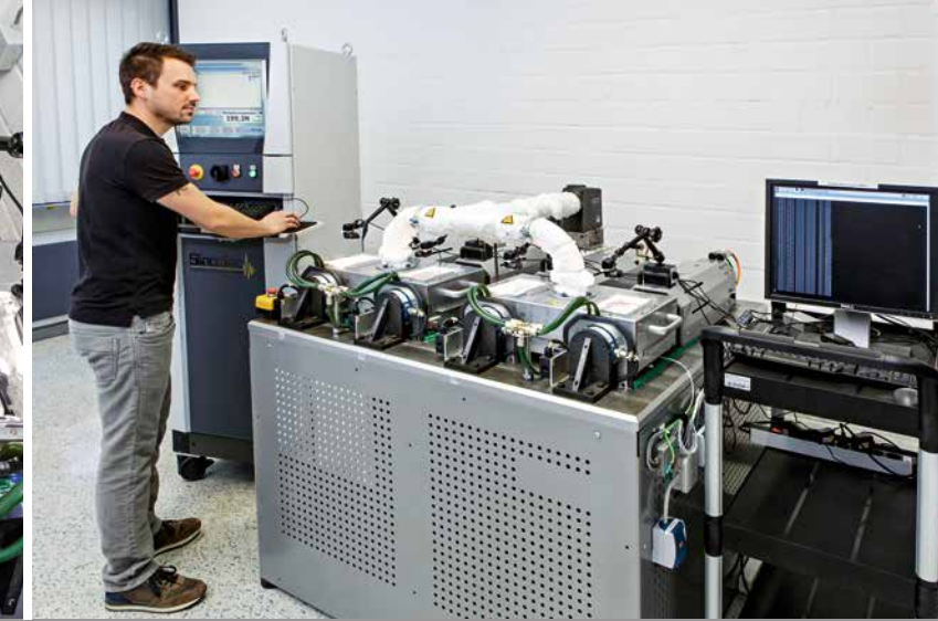
Elektromechanisches Prüfsystem zur kostengünstigen Lebensdauerprüfung von Elastomerproben. Electromechanical test system for an inexpensive fatigue life test of elastomer specimens.
