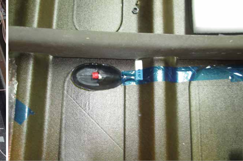
Fraunhofer LBF Konnektor für integrierte Sensoren in Composite Strukturen. Fraunhofer LBF connector hub for integrated sensors in composite structures.
