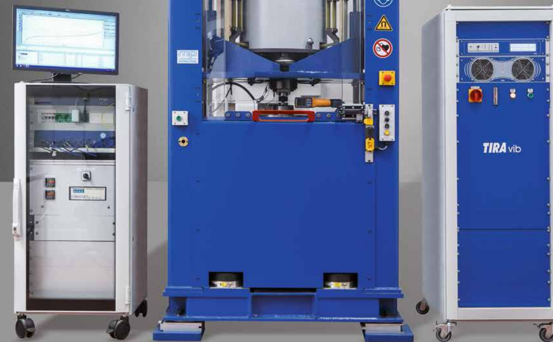
Mit einer Frequenz von bis zu 2000 Hertz lassen sich Werkstoffe und Bauteile mit dem neuen Hochfrequenzprüfstand des Fraunhofer LBF untersuchen. Fraunhofer LBF's new high frequency test rig can be used to examine materials and components with a frequency of up to 2000 Hz.
