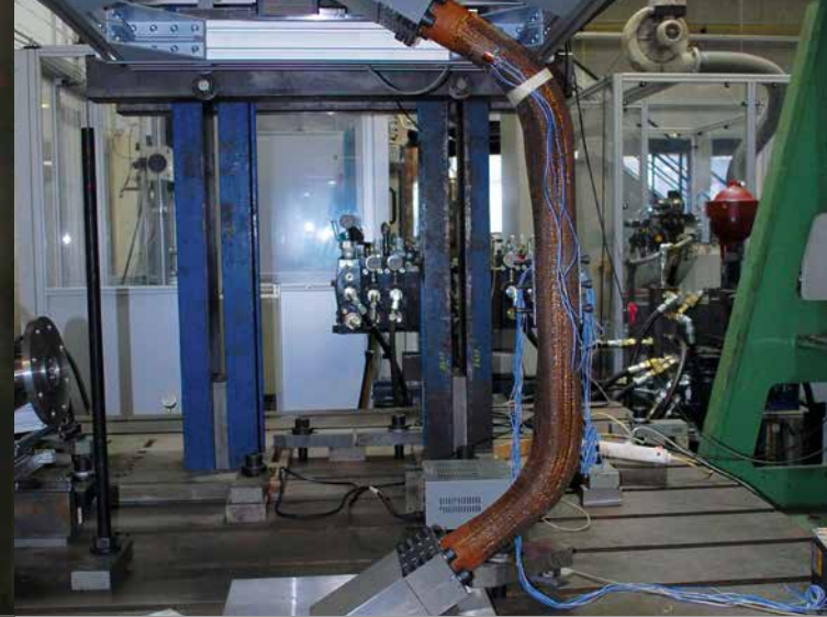
Experimentelle Prüfung der CFK-Komponente der Leichtbauhinterachse. Experimental testing of CFRP-component of lightweight rear axle.
