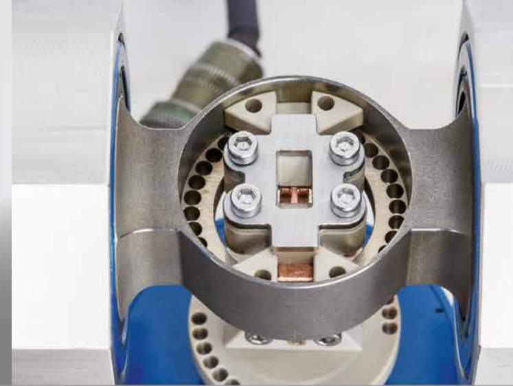
Reibungsoptimierte Lagerung bei höchster Prüfstandssteifigkeit. Friction optimized highstiffness bearing system.
