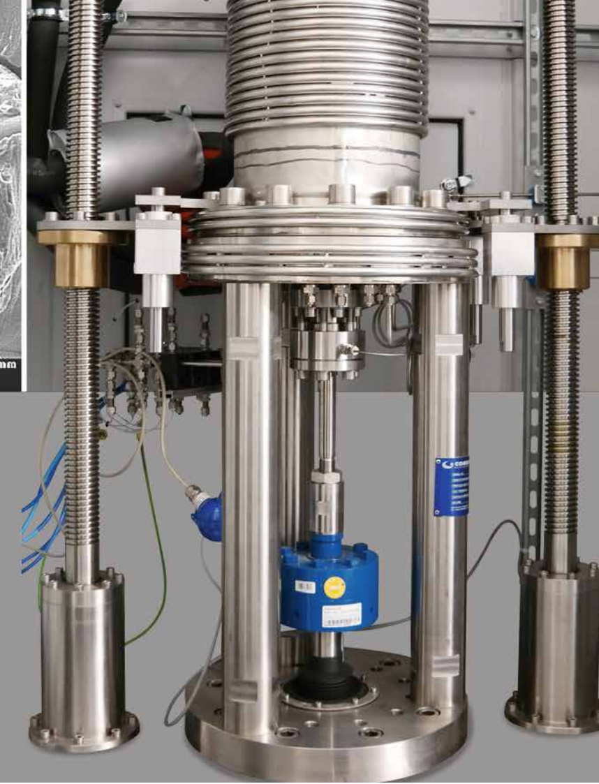
Abb. 3: Prüfeinrichtung zur Durchführung von temperierten Ermüdungsversuchen unter Druckwasserstoff, Stickstoffatmosphäre und Umgebungsluft. Fig. 3: Test facility for performance of fatigue tests under pressurized hydrogen as well as nitrogen and air atmosphere.
