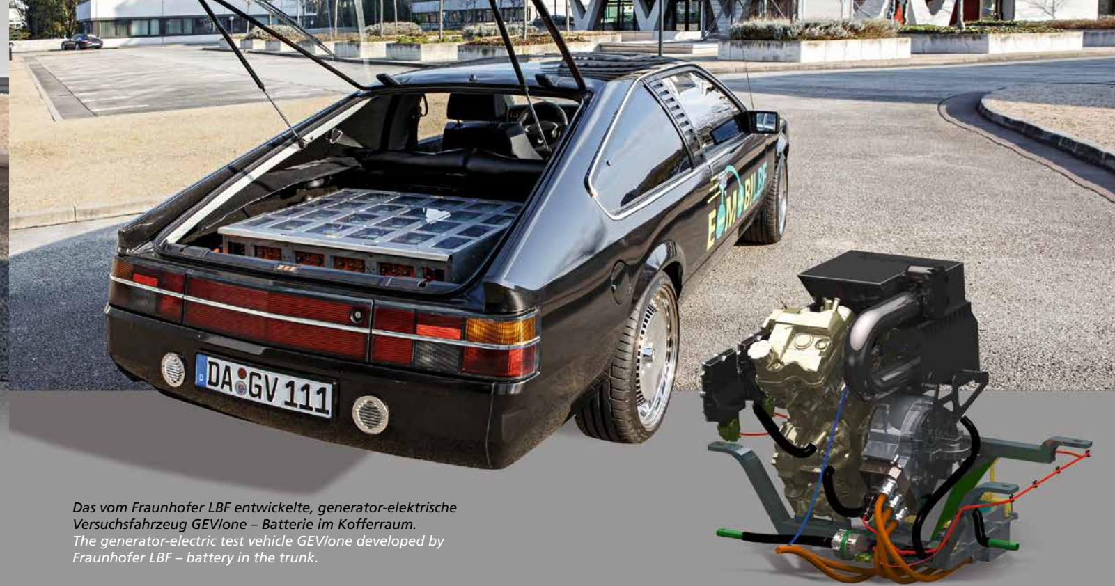
Eingebauter Gasmotor im Versuchsfahrzeug GEV/one. Gas engine installed in the test vehicle GEV/one.
