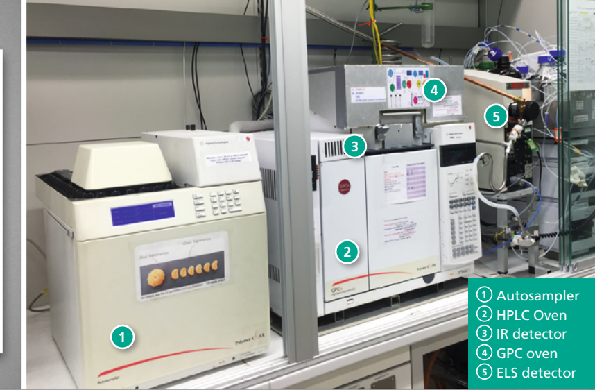
Abb. 2: Gerät, das zur Trennung von Polyolefinen mittels 2-dimensionaler Hochtemperaturflüssigchromatographie eingesetzt wurde. Fig. 2: Instrument used for separation of polyolefins with high-temperature 2-dimensional liquid chromatography.
