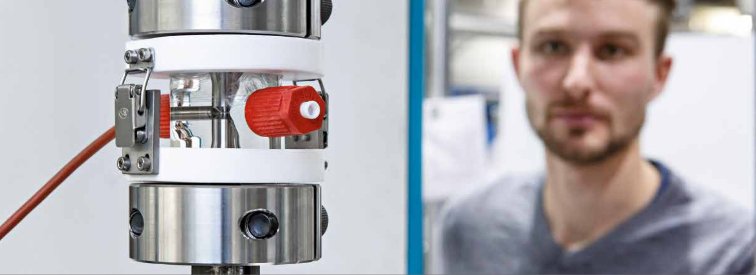
Abb. 1: Medienkammer für die Prüfung von Werkstoffproben in Kraftstoff mit Temperaturmessung Fig. 1: Media chamber for testing material specimens in fuel with temperature measurement.
