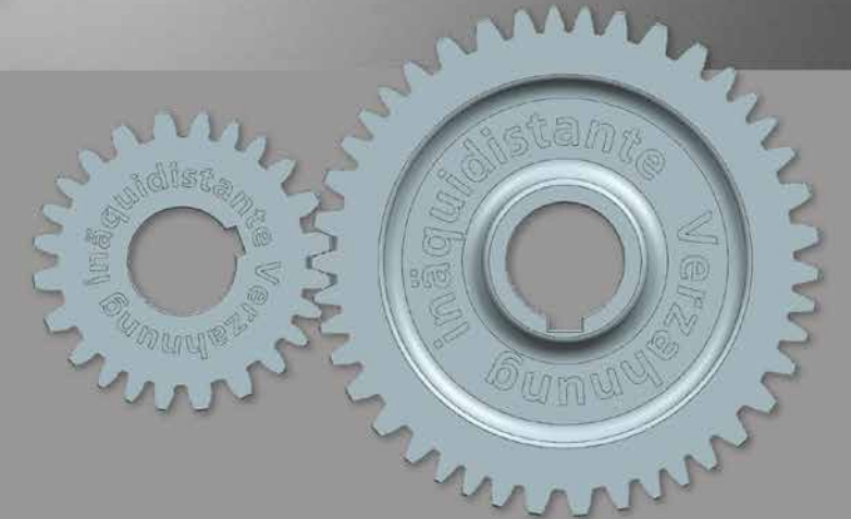
Abb. 4: Ausführungsbeispiel einer inäquidistanten Verzahnung mit unregelmäßigen Zahndicken und Zahnpositionen. Fig. 4: Example of an inequidistant gearing with irregular tooth thicknesses and tooth positions.
