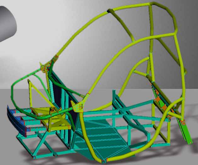
Leichter Rahmen für Elektrofahrzeuge. Lightweight frame for electric vehicles.
