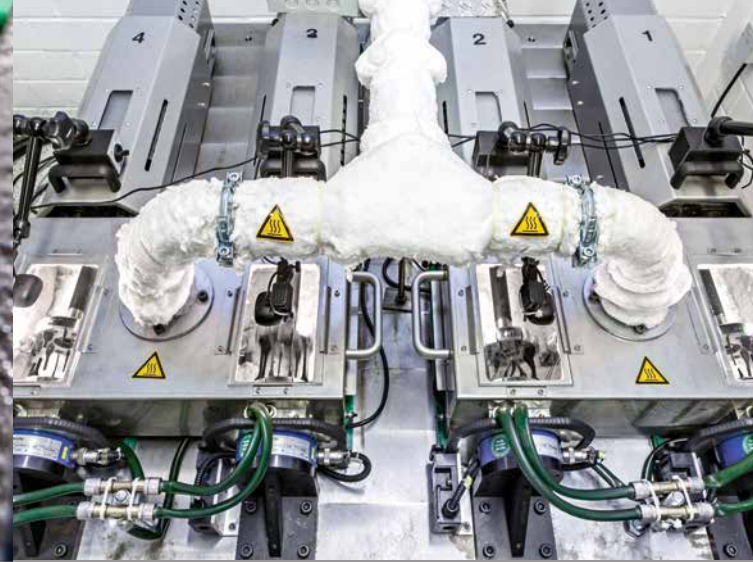
Elastomerprüfung bei erhöhten Umgebungstemperaturen bis 200 °C. Elastomer testing at increased ambient temperatures up to 200 °C.
