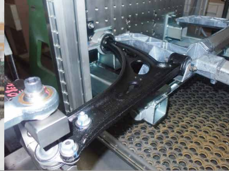
Betriebsfestigkeitsuntersuchung im Fraunhofer LBF. Structural durability test at Fraunhofer LBF.
