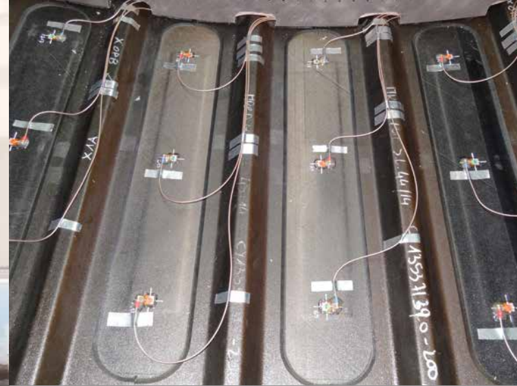
Der hochpräzise Messaufbau aus dem Fraunhofer LBF kann die Verformungen an CFK-Strukturen sehr genau erfassen und darstellen. The high-precision measurement setup from Fraunhofer LBF can detect and display the deformations to carbon fiber structures very accurately.
